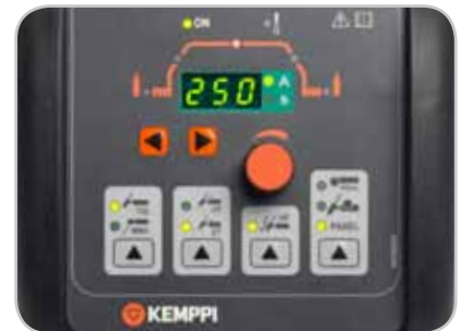
Панель управления MasterTig LT 250: выбор процесса TIG или MMA, высокочастотного или контактного зажигания, фиксирование курка сварочной горелки и выбор дистанционного управления. Отображение сварочного тока, регулировка подачи газа до и после сварки, таймер увеличения/уменьшения сварочного тока.
