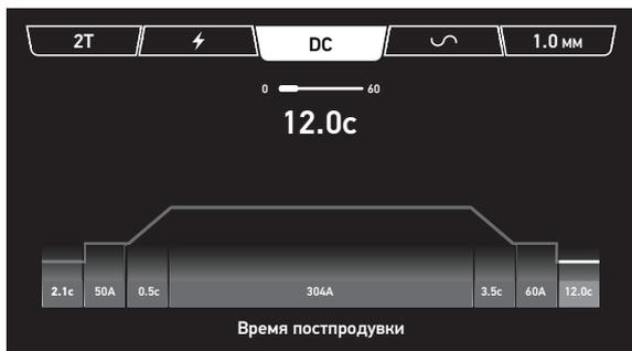
**Пред продувка газом.** Диапазон регулировки 0-10 сек
