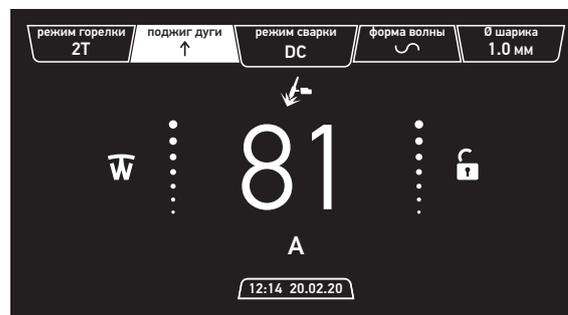
**Бесконтактный** – поджиг осуществляется импульсом высокого напряжения
