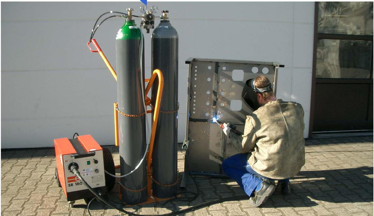
Не нужно запасаться баллонами с различными готовыми газовыми смесями, потому что, имея баллон с аргоном и баллон с углекислым газом, можно произвести самостоятельно смесь в пропорции 0-25% CO<sub>2</sub> в аргоне.
