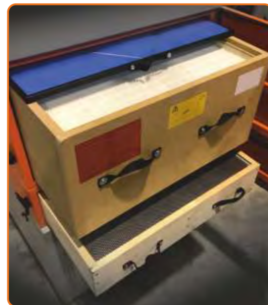
Расположение фильтроэлементов внутри агрегата
