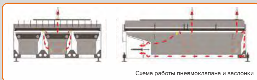
Общая схема работы вытяжного стола
