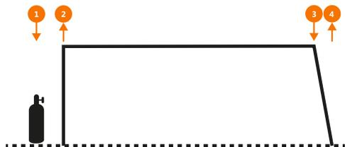
**Рисунок 45. Логика 4Т кнопки сварочной горелки**
