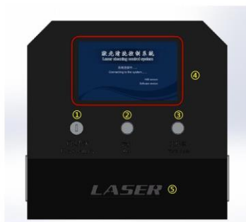
Рисунок 3.1.1. Панель управления установкой высокоэффективной лазерной очистки
