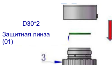
Рисунок 3.4.7. Схема демонтажа защитной линзы
