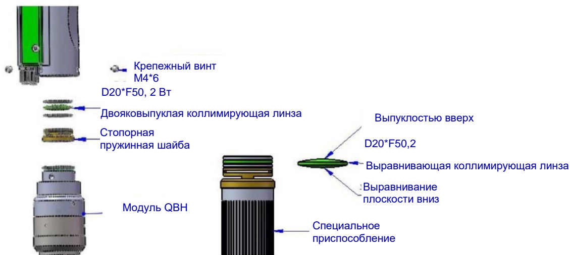
Рисунок 3.4.3. Разборка и сборка коллимирующей линзы
